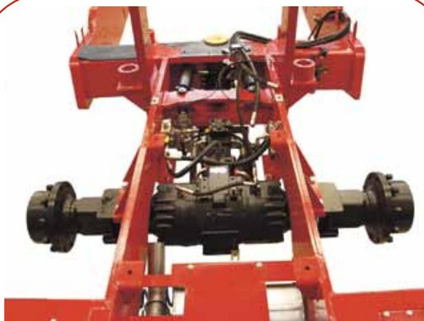
**Система ограничения пробуксовки задней оси**
