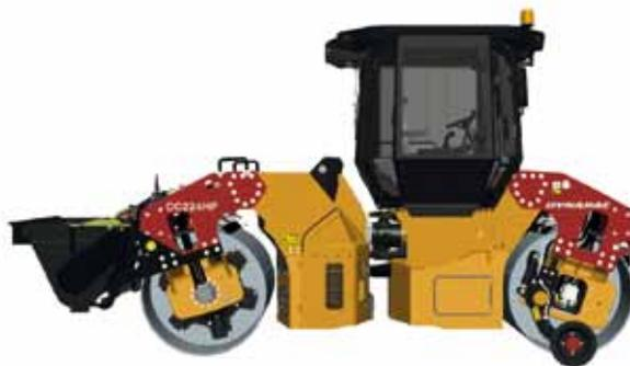
Используется для создания покрытия с более высокими показателями сцепления, чем это может обеспечить обычный асфальт. Также используется для создания цветного покрытия — для выделения тротуара или велосипедной дорожки. Опция доступна для асфальтовых катков Динапак CC224HF-CC334HF.
