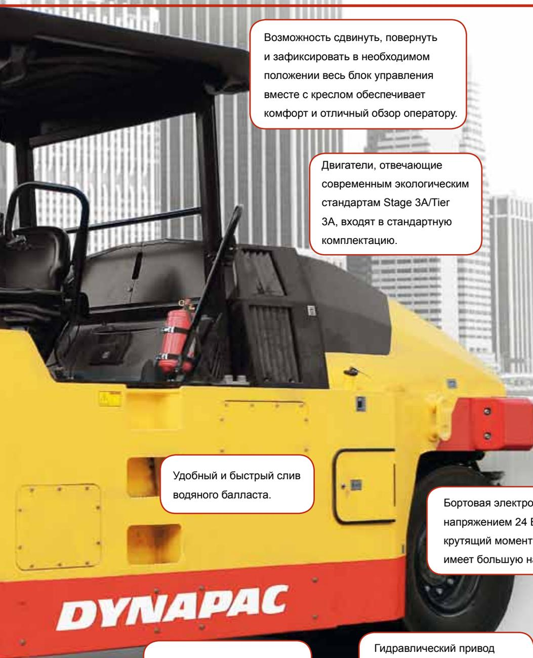
Возможность сдвинуть, повернуть и зафиксировать в необходимом положении весь блок управления вместе с креслом обеспечивает комфорт и отличный обзор оператору.
